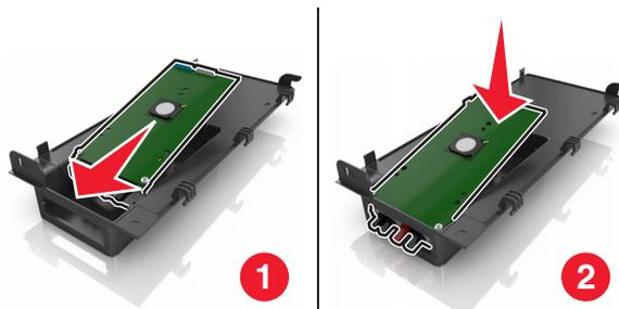
**6** Prenda a solução ISP no suporte de plástico usando um parafuso longo.
