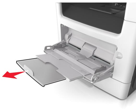
2 Aperte a guia na guia de largura esquerda e mova as guias para o tamanho do papel sendo colocado.
