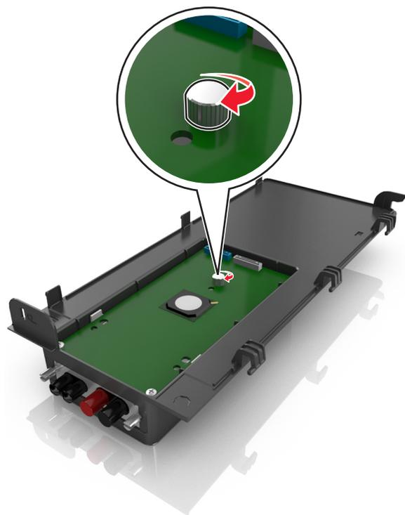
**7** Aperte os dois parafusos na extremidade da solução ISP.
