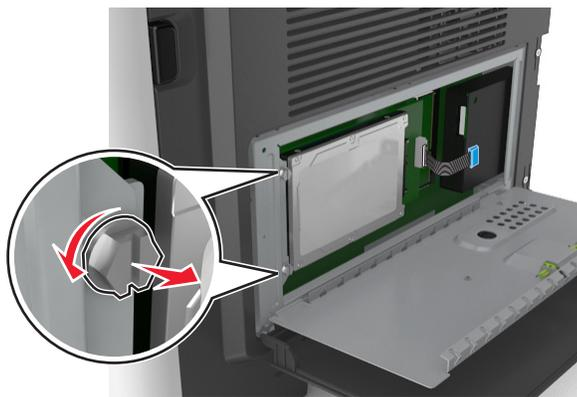
**3** Desconecte o cabo de interface do disco rígido da impressora do receptáculo na placa de controle, deixando o cabo conectado ao disco rígido da impressora. Para desconectar o cabo, aperte a pá no plugue do cabo de interface para soltar a trava antes de retirar o cabo.
