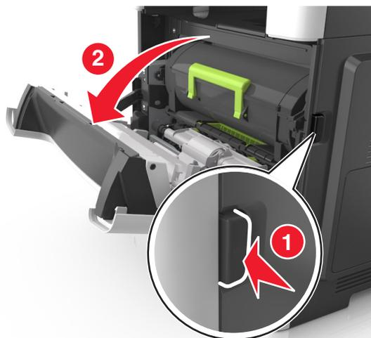
2 Extraiga el cartucho de t nner mediante la palanca.
