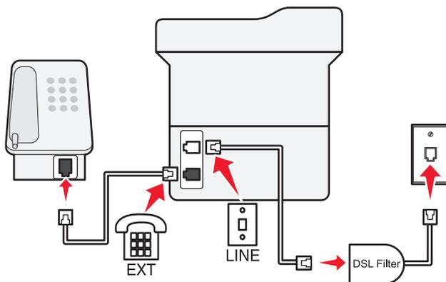
Una línea digital de abonado (DSL) divide la línea de teléfono habitual en dos canales: voz e Internet. Las señales de teléfono y fax viajan a través del canal de voz mientras que la señal de Internet transcurre por el otro canal.
