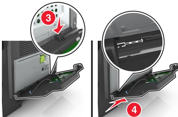
**11** Pase el cable del ISP a través de la protección de la placa de la controladora.
