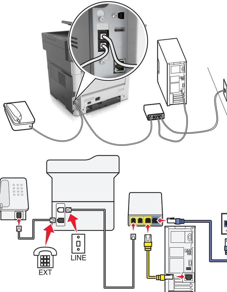
**1** Conecte un extremo del cable telefónico al puerto LINE de la impresora.
