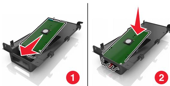
6 Asegure la solución ISP al soporte de plástico usando el tornillo largo.
