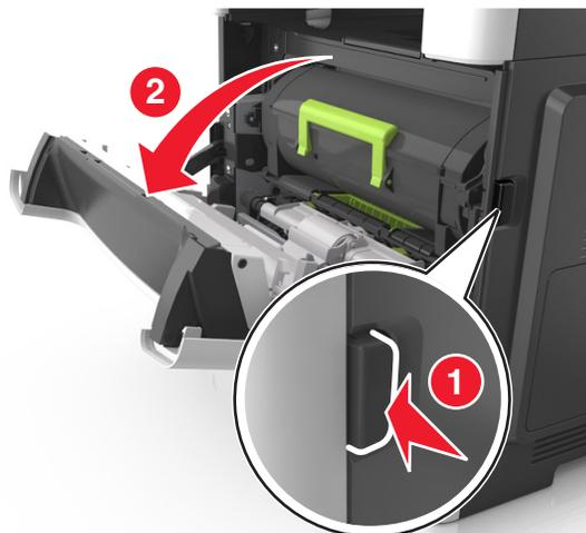
2 Extraiga el cartucho de tóner mediante la palanca.
