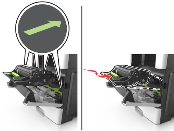
**7** Para introducir el cartucho de tóner en la impresora, alinee los carriles laterales del cartucho con las flechas de los carriles laterales dentro la impresora.
