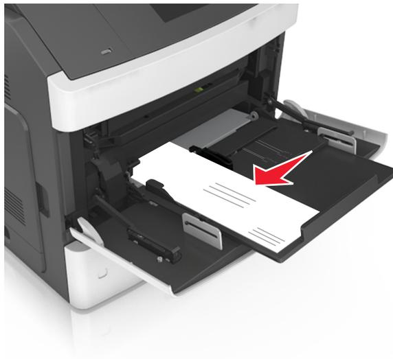
**Warnung—Mögliche Schäden:** Es dürfen keine Umschläge mit Briefmarken, Metallklammern, Haken, Fenstern, Fütterung oder selbstklebenden Aufklebern verwendet werden. Durch solche Umschläge kann der Drucker schwer beschädigt werden.
