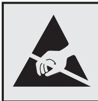
Mit diesem Symbol sind Teile gekennzeichnet, die gegen statische Aufladungen empfindlich sind. Berühren Sie die Bereiche um diese Symbole erst, nachdem Sie einen Metallgegenstand in einem entfernten Bereich zu dem Symbol berührt haben.
